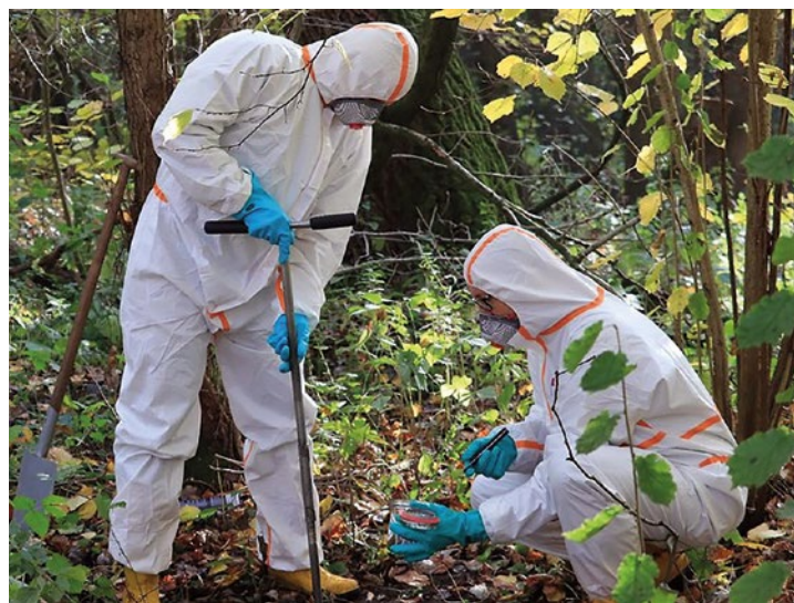
Probenahme bei einer Altlastenverdachtsfläche
